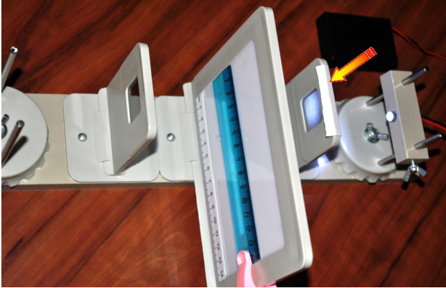
1B ábra A vonalzó kettőtörésének vizsgálatára összeállított elrendezés
