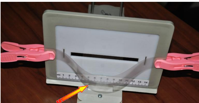
1B ábra A vonalzó kettőtörésének vizsgálatára összeállított elrendezés
