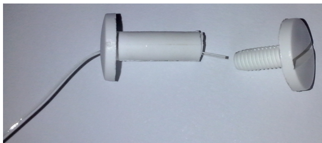
6. ábra: A TPU szál rögzítése a csavarhoz.
